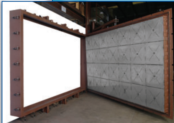
CATALYST MODULE REMOVAL DOOR
